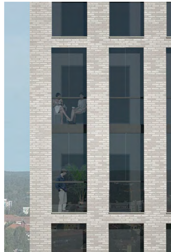
Kahden kerroksen korkuinen julkisivujako, parvekejulkisivu Periaatekuva
